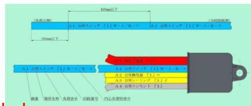
赤色:分電盤、青色:スイッチ、黄色:照明・換気扇等のスイッチ負荷、灰色:コンセント の4色で色分けしています。300mm間隔でケーブルの行先を連続表示しているため、迷うことなく施工できます。
